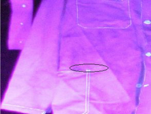
Kuva 30. Kemikaaliroiskeiden määrittäminen suojavaatteesta. Suojavaatteen kemikaaliroiskealue on ympyröity.
